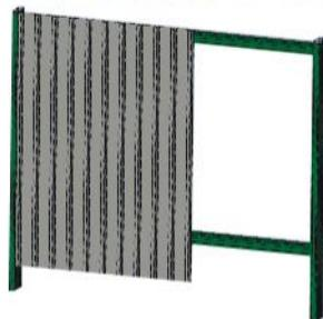
Система состоит из столбов сечением 60x60 (или 40x60) и лаг (горизонтальных перемычек) сечением 40x60. Сборка производится без применения сварки. Для крепления лаг к столbam применяются опорные скобы.
