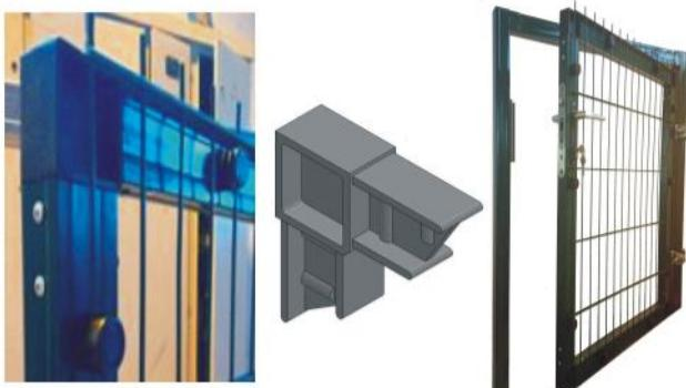
Вместо сварки в углах каркаса калитки устанавливаются специальные вставки-переходники из прочного пластика, которые позволяют крепить вертикальные и горизонтальные профили каркаса под 90°. Калитка поставляется в полной комплектации, но в разобранном виде, что позволяет упростить процесс доставки к месту монтажа.
